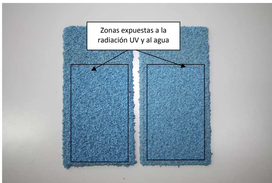
Figura 2. Revestimiento de corcho proyectado DECOPROYEC después de 1000 horas de exposición a la radiación UV y al agua
