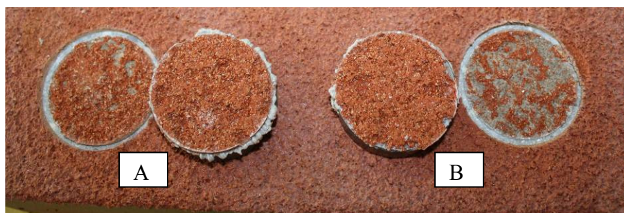
Figura 1. Superficies separadas después del ensayo de tracción. A) B: 100% Fallo cohesivo del corcho proyectado y B) Fallo mixto 50% A/B – 50% B: 50% fallo adhesivo entre el corcho proyectado y el soporte de hormigón y 50% fallo cohesivo del corcho proyectado
